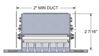
□ L LINEAR STRAIGHTENING GRID
